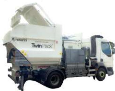
**Figura 39 - Veicolo con pinza laterale**
