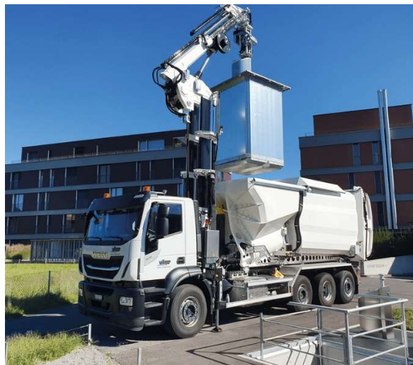
Figura 34 - Mezzo operativo per svuotamento strutture interrato
